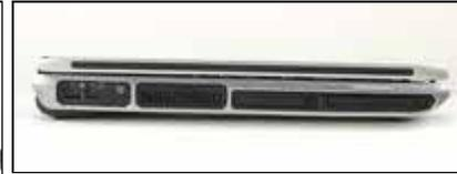
【左側面】 左側面には、Ethernet、モデム、CF Typell、PCカード Typell、SDカード / メモリスティック兼用スロットを装備。
