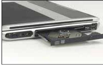
【DVDマルチドライブ搭載！】 交換可能な拡張ベイには、標準でDVDマルチドライブを搭載。オプションのセカンドバッテリーと交換すれば、約7時間(標準バッテリー時)のバッテリー駆動が可能になる。
